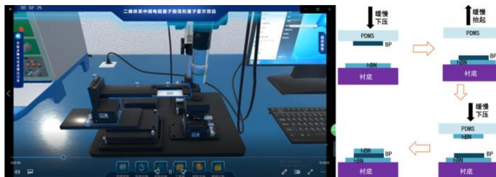
图 14 干法转移制备叠层 hBN/BP/hBN
